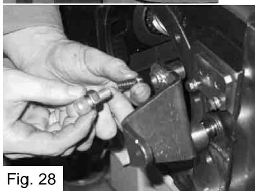
Come illustrato in fig. 28 con la vite a brugola si precarica la molla per ottenere una pressione sulla sfera tale che non si disinnesti la selezione impostata con le vibrazioni e le condizioni di lavoro della macchina, quindi si serra il controdado .
