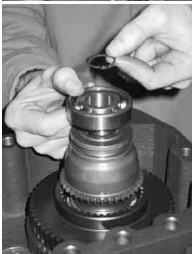
Completare il montaggio con il manicotto di selezione, il cuscinetto e il seeger di fermo del cuscinetto. Non dimenticare prima del montaggio finale della culatta di posizionare la forcella di selezione delle velocità della presa di forza, all'interno del forcellino di comando montato in precedenza.
