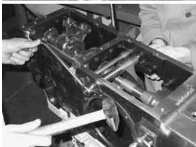
Come illustrato anche nelle due foto qui a lato, montare il pedale del bloccaggio differenziale e completare anche questa parte del montaggio.
