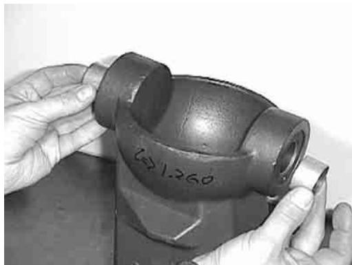
Nella foto qui a lato viene mostrato il montaggio del rasamento da interporre tra le due flangie dell'articolazione dello sterzo, che viene trattenuta ferma dalla spina visibile in fotografia part. E di fig. 5.
