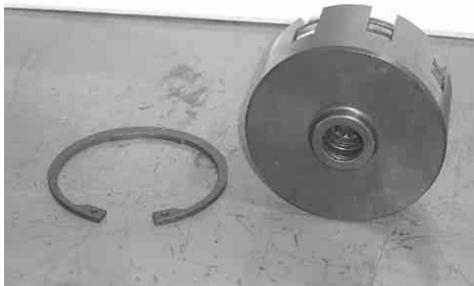
Montare poi il manicotto selezione della presa di forza sull'albero primario facendo attenzione alla tornitura interna del manicotto che deve essere orientata verso il motore una volta che l'albero e' montato all'interno del carter cambio come illustrato in fig. 9.
