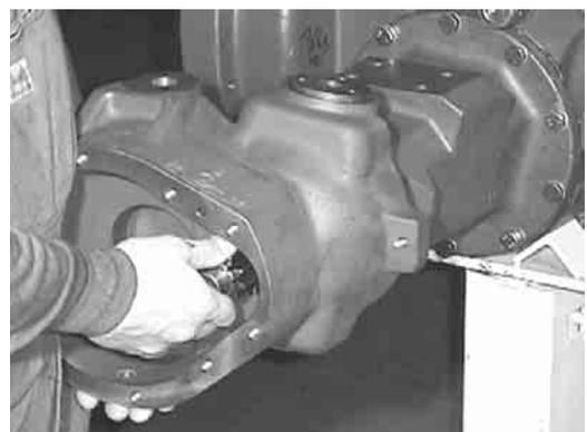
Montare la chitarra esterna del mozzo andando a posizionare i perni di snodo nelle apposite sedi e ruotare con la mano il semiassse per centrare la calettatura all'interno del differenziale anteriore.
