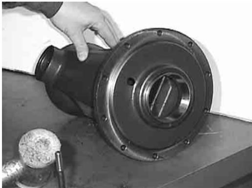
Una volta montato il differenziale anteriore, per il cui montaggio e registrazione si rimanda al capitolo specifico, si può procedere all'assemblaggio dei riduttori anteriori al gruppo carro, partendo dalla parte rigida, rappresentata nella foto qui accanto e procedendo poi con le altre parti.
