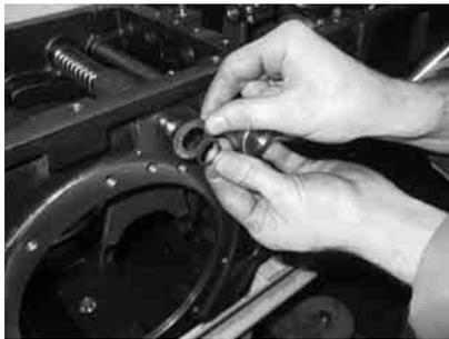
Montare ,come già' illustrato anche in precedenza, l'OR, il distanziale di contenimento e successivamente il mozzo del pedale bloccaggio differenziale anche per quello che riguarda il leveraggio esterno del bloccaggio differenziale.
