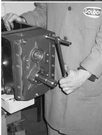
A serraggio completato verificare che la forcella azionata esternamente faccia innestare il manicotto: mentre con una mano si ruota la presa di forza, con l'altra mano si prova l'innesto.
