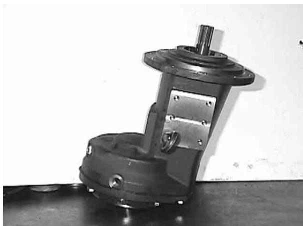
A differenza della versione RS, nella versione SN il semiasse e il mozzo sono comunicanti con il carter differenziale anteriore e l'olio per la lubrificazione del riduttore viene dalla scatola differenziale.
