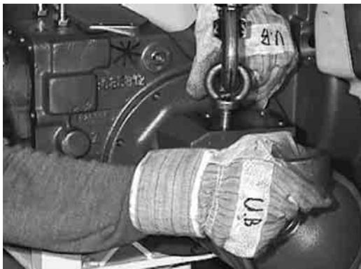
Fissare la parte rigida del riduttore anteriore avvalendosi dell'aiuto di un paranco come in foto qui a lato serrando le viti di fissaggio in modo provvisorio solo per posizionare il particolare.
