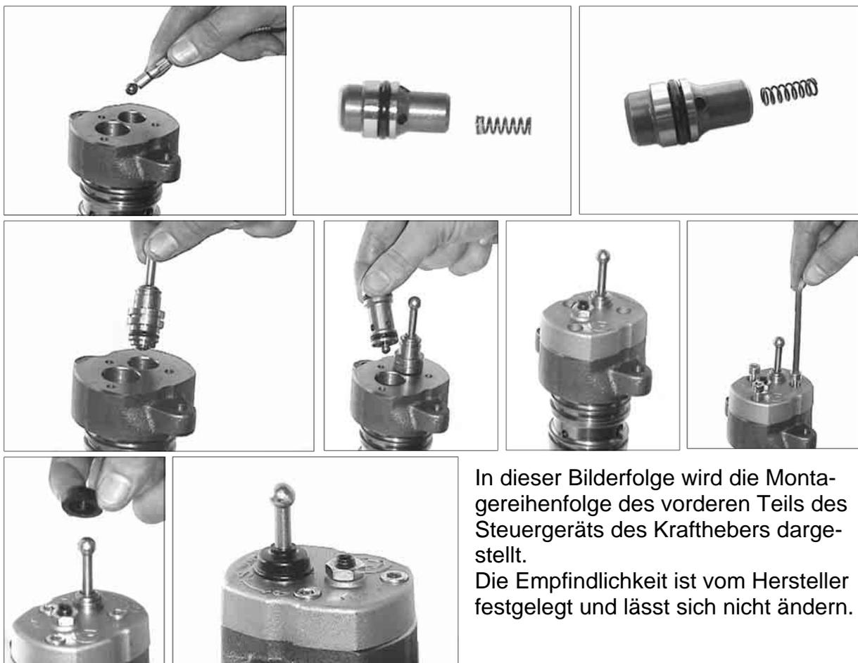
In dieser Bilderfolge wird die Montagerihenfolge des vorderen Teils des Steuergeräts des Krafthebers dargestellt.
