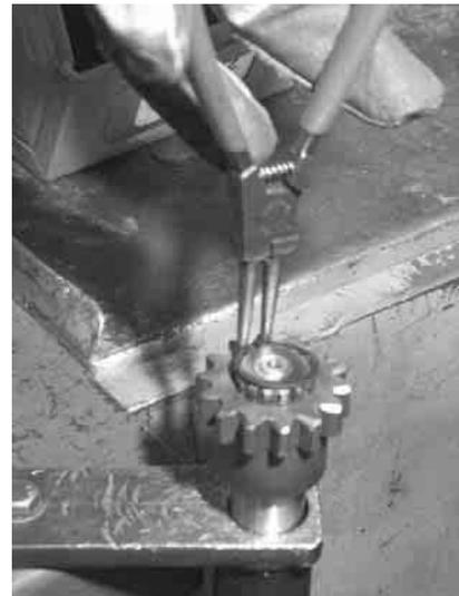
Nach dem Einstecken dieser Welle auf der Rückseite des Gehäuses kann man die abschließenden Montageschritte am Getriebegehäuse ausführen, d.h. das Einstecken des vorderen Teils der Hauptwelle und des Deckels, auf dem das Drucklager der Kupplung arbeitet.
