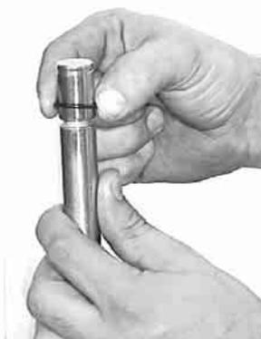
Die Stange ölen, auf der dann die O-Ringe montiert werden, die Stange dann sorgfältig in ihre Aufnahme stecken und dabei prüfen, dass der O-Ring nicht wie in Abb. 23 gezeigt gezwickt wird.
