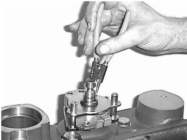
In der oben dargestellten Bildsequenz wird die Reihenfolge der Montage der Innenwelle für die Positionsregelung dargestellt.
