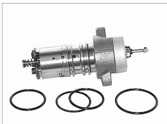
Beim Wiederausammenbau des Blocks des Steuergeräts sicherstellen, dass alle O-Ringe des Bilds links einen einwandfreien Zustand aufweisen und nicht gequetscht worden sind. Dies würde nämlich zu Betriebsstörungen und weiteren Eingriffen an der Gruppe führen.
