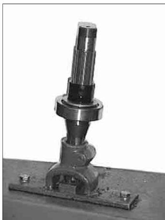
Nella sequenza qui accanto viene illustrato il montaggio della culatta presa di forza. Prima di iniziare il montaggio degli ingranaggi posizionare all'interno della culatta la forcella di selezione e i particolari evidenziati in fig 3.
