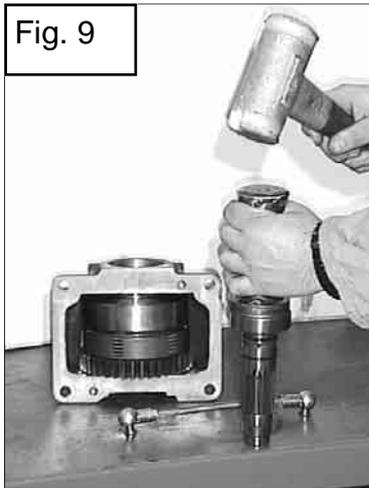
Durante l'inserimento dell'albero all'interno del pacco frizioni, lubrificare le tenute con olio o grasso per evitarne il danneggiamento.
