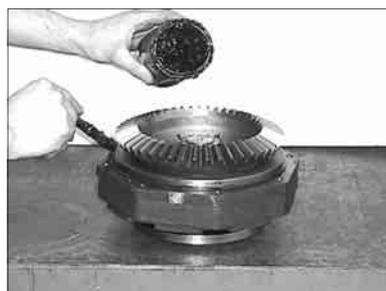
Nella sequenza riportata nella pagina precedente, è illustrato il montaggio del riduttore anteriore con frenatura anteriore. La sequenza mostra le diverse fasi del montaggio partendo dalle prime operazioni fino all'applicazione del riduttore sulla croce centrale del differenziale anteriore.
