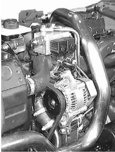
Nelle foto, qui a lato, viene illustrata la diversa collocazione sulla macchina con motorizzazione J.D. del gruppo elettrovalvole di comando inserimento doppia trazione e bloccaggio differenziale.
