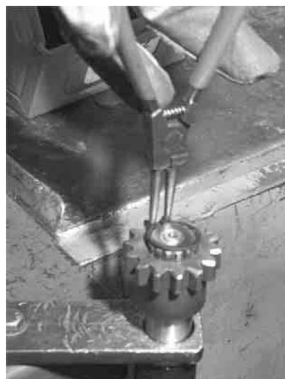
Una volta inserita la frusta dal lato posteriore del carter, si può procedere con le ultime fasi del montaggio della scatola cambio, ovvero l'inserimento della parte anteriore dell'albero primario e del coperchio sul quale lavora il cuscinetto reggispinna della frizione.
