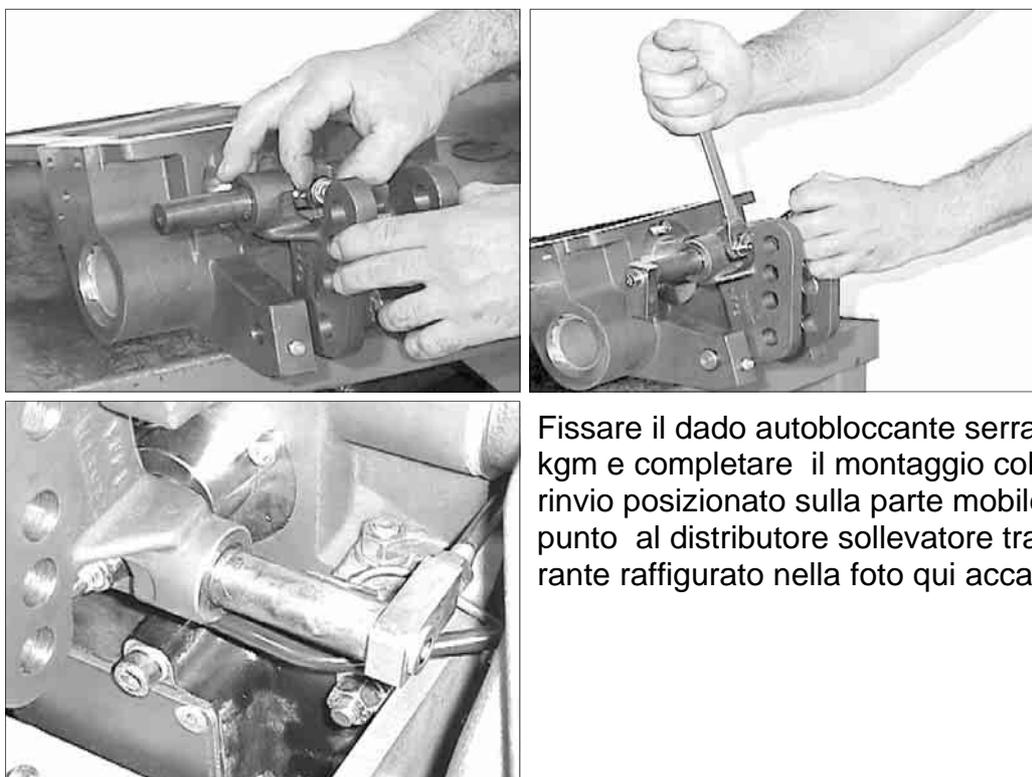
Fissare il dado autobloccante serrandolo a 3 kgm e completare il montaggio collegando il rinvio posizionato sulla parte mobile del terzo punto al distributore sollevatore tramite il tirante raffigurato nella foto qui accanto.
