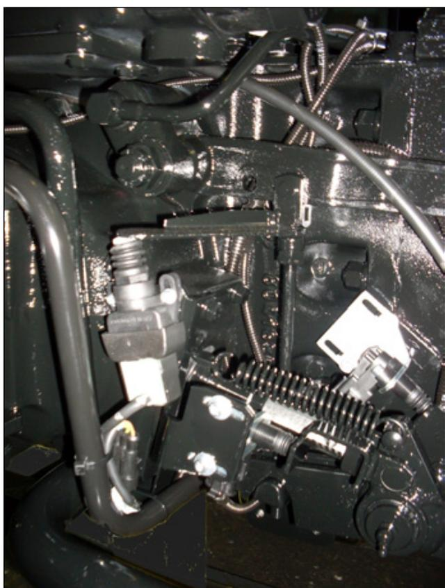
Nel caso sia necessario sostituire il coperchio di protezione sul mozzo dx occorre smontare il tirante di collegamento della leva rinvio freno al tirante della massa frenante, la molla di ritorno, il supporto con l'interruttore freni e la flangia attacco coperchio.
