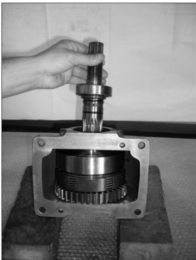
A questo punto rimontare il gruppo precedentemente provato a banco all'interno della scatola trazione, sostituendo il distanziale fisso di prova con il cuscinetto previsto.
