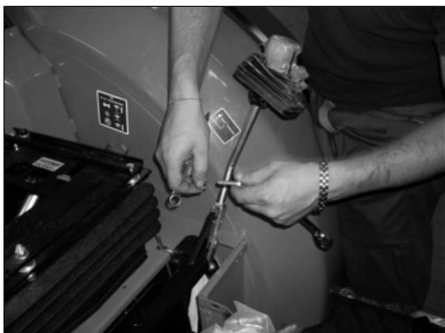
Smontare la leva di comando riduttore.
