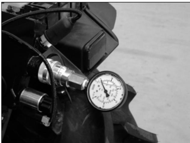
Collegare all'uscita **(N)** della valvola freno un manometro con attacco femmina ISO 5676. Accendere il motore della trattrice.
