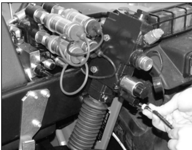
Collegare i due faston della connessione **(G)** al pressostato **(M)**. Ricoprire con il cappuccio in gomma già presente sul cablaggio.
