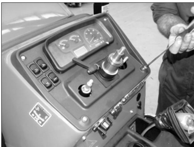
Rimuovere il volante, la leva comando inversore, la leva acceleratore a mano, la leva di regolazione altezza volante.
