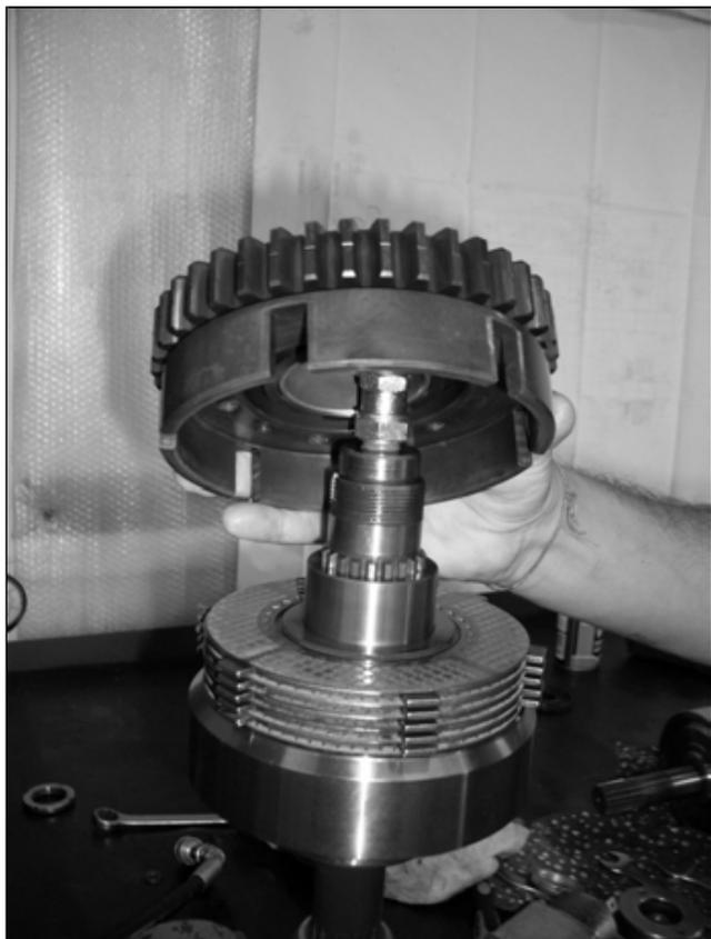
Rimontare il pacco frizione, alternando i 6 dischi frizione ai 5 dischi fissi.
