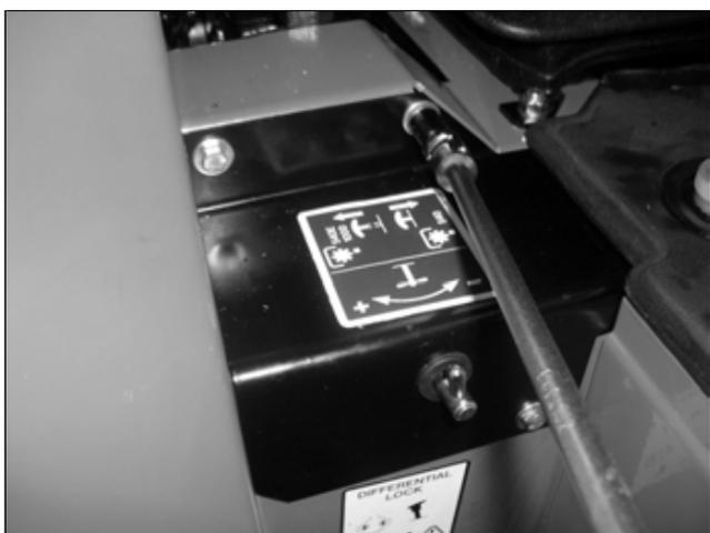
Smontare l'impugnatura della regolazione discesa sollevatore ed il coperchio di protezione del distributore sollevatore.
