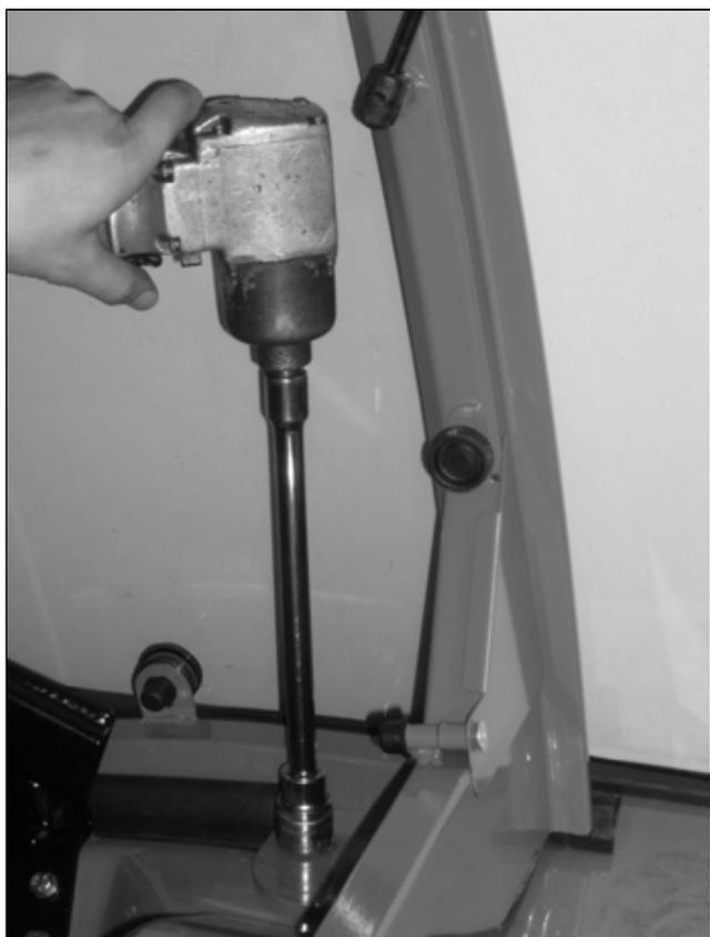
Svitare le viti di fissaggio della cabina ai parafranghi posteriori.
