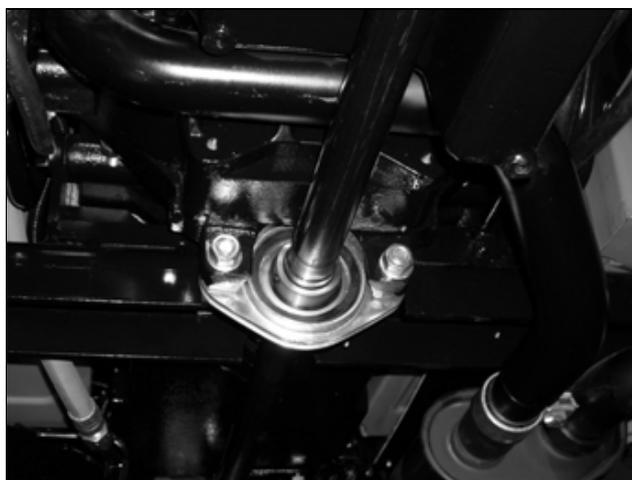
Smontare la protezione dell'albero di trasmissione, togliere il seeger di fermo e spostare il manicotto sull'albero di trasmissione, sia lato anteriore sia lato posteriore, svitare le due viti di fissaggio del supporto cuscinetto dell'albero di trasmissione e togliere l'albero di trasmissione.
