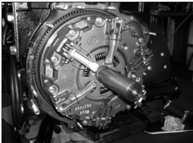
Nel rimontare il gruppo frizione sul volano, utilizzare l'apposito perno per il centraggio dei dischi frizione cod. 07000226 e serrare le viti a 4 Kgm. Si raccomanda di sostituire le viti M8 di fissaggio frizione.
