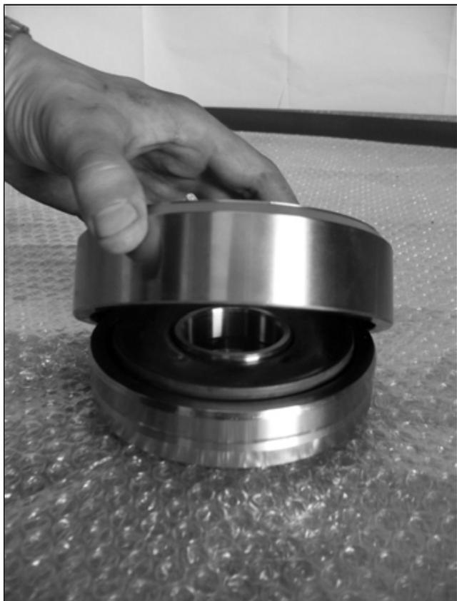
Rimontare il pistone all'interno del tamburo prestando attenzione a non danneggiare gli anelli di tenuta. Come illustrato nel complessivo di montaggio di fig. 1 le molle a tazza vanno montate contrapposte (a due a due) e ci si deve avvalere dell'aiuto di una pressa con una capacità di carico di almeno 500 kg.
