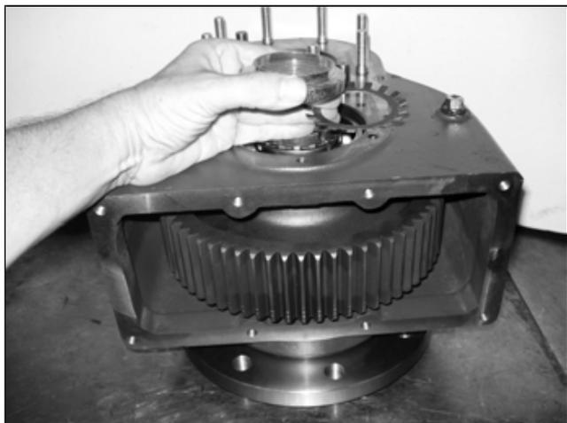
Montare il semiassse all'interno del carter riduttore, facendo attenzione nel posizionare l'ingranaggio riduttore ed il distanziale che andrà in battuta sul cuscinetto interno.
