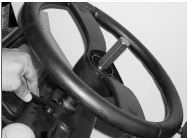
Smontare il volante con l'apposito estrattore cod. 07006212, la leva comando acceleratore a mano, la leva comando inversore, la leva regolazione altezza volante ed infine il cruscotto porta strumenti.
