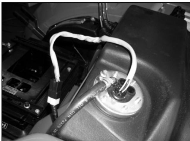
Scollegare il cavo del rilevatore livello carburante e togliere il tubo gasolio.
