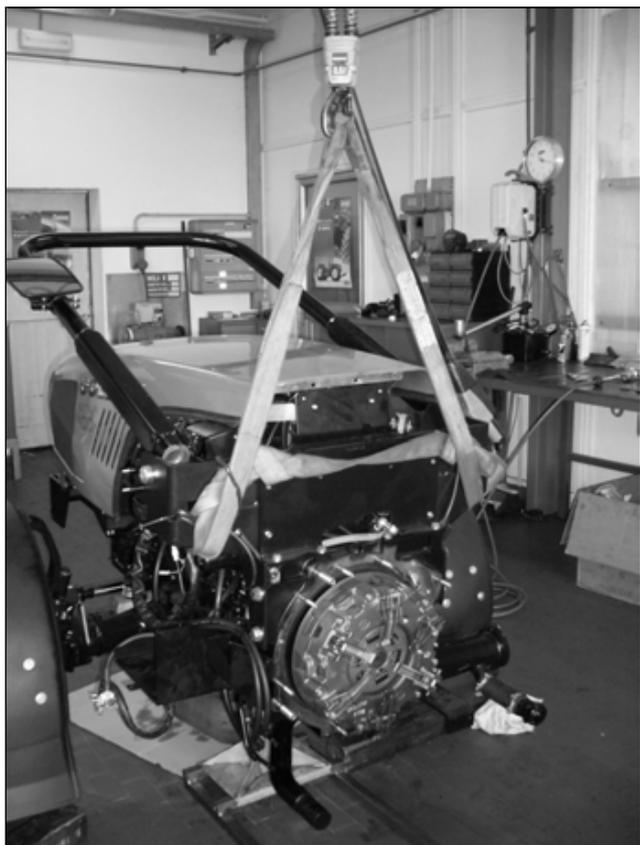
Assicurare le due parti della macchina con l'apposito supporto per la separazione della trattore cod. 07000245.
