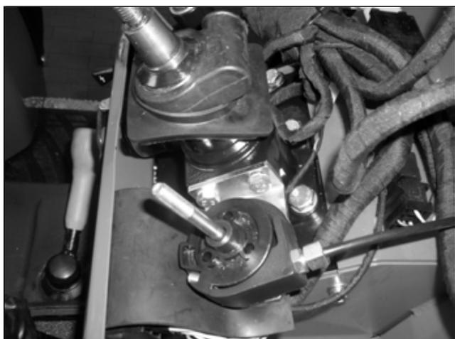
Smontare il supporto del comando acceleratore a mano.
