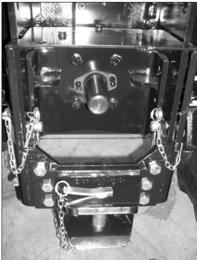
Per revisionare o sostituire il gruppo presa di forza posteriore occorre eseguire le seguenti attività: smontare il gancio di traino completo, la protezione della presa di forza e la lama di irrigidimento slitte.
