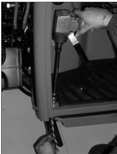
Svitare le viti anteriori di fissaggio della cabina al supporto anteriore modulo guida.
