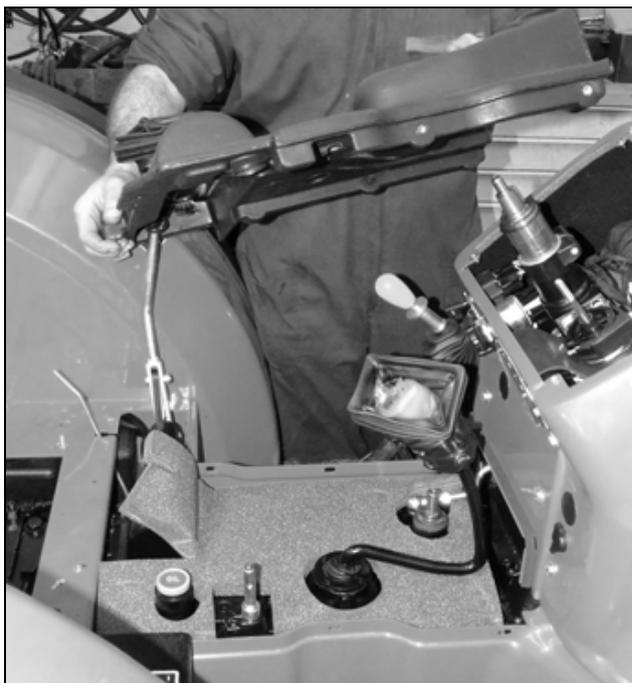
Rimuovere dalla trattrice il sedile completo di molleggio, la protezione leve sollevatore, la copertura in plastica del tunnel e la sottostante insonorizzazione.
