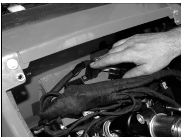
Estrarre il relè **A** come da figura, fissare il supporto relè sul foro filettato già presente sulla piattaforma e reinserire il relè.
