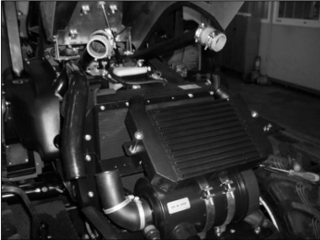
Smontare il supporto completo con il radiatore intercooler montato.
