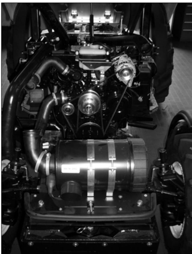
Per smontare la cinghia di trasmissione dell'alternatore, occorre allentare la vite di tensionamento dell'alternatore e sfilarla. Nella versione con cabina, l'alternatore si trova sulla dx e la procedura di smontaggio è la stessa.
