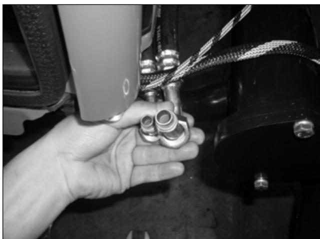
Rimontare la cabina ripetendo le operazioni al contrario. Nel rimontare la cabina occorre fare particolare attenzione agli anelli di tenuta sui tubi dell'aria condizionata. Tramite l'apposita macchina (unità automatica per vuoto e carica del refrigerante dal sistema A/C) ricaricare l'impianto dell'aria condizionata, collegandosi agli appositi raccordi sui tubi di collegamento al compressore, utilizzando il gas tipo R134A nella quantità prevista di 0,8 Kg.
