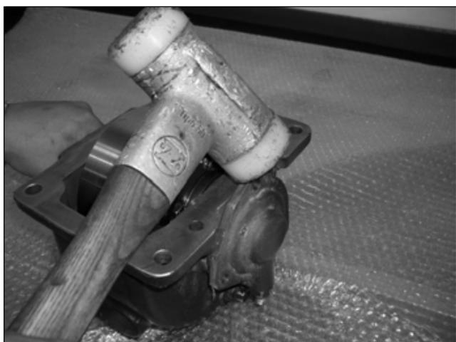
Svitare le viti di fissaggio del coperchio e rimuovere il coperchio posteriore.
