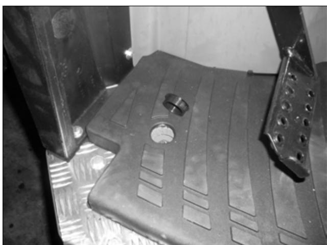
Svitare le viti anteriori di fissaggio della piattaforma al supporto anteriore modulo guida.
