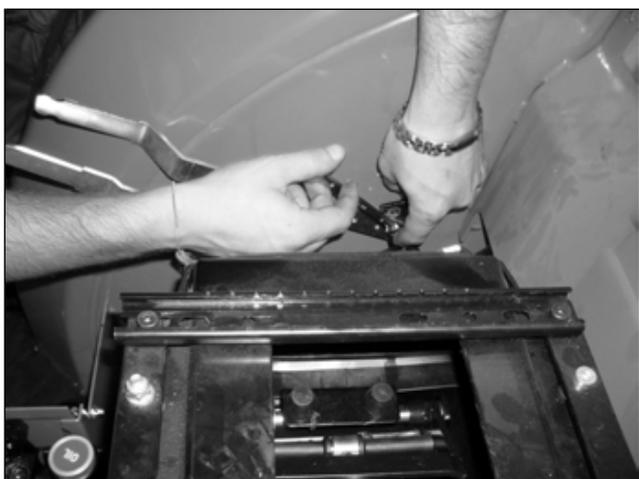
Smontare le leve di comando sollevatore ed il tubo idraulico di mandata dai distributori ausiliari al distributore del sollevatore.
