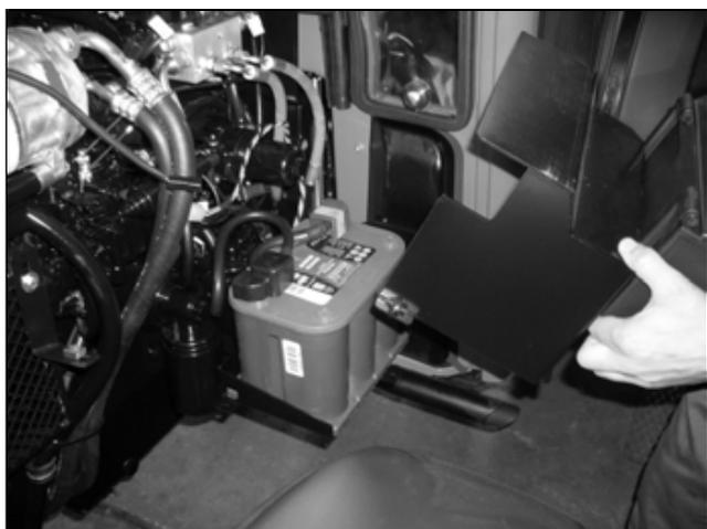
Smontare la protezione della batteria e scollegare i cavi elettrici.
