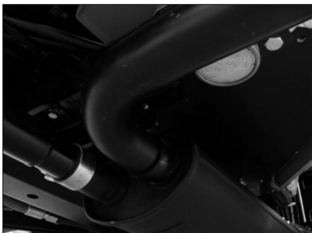
Svitare la fascetta di fissaggio del silenziatore al tubo di scarico del motore, svitare la vite di fissaggio della lama supporto marmitta al mozzo posteriore e smontare la marmitta.
