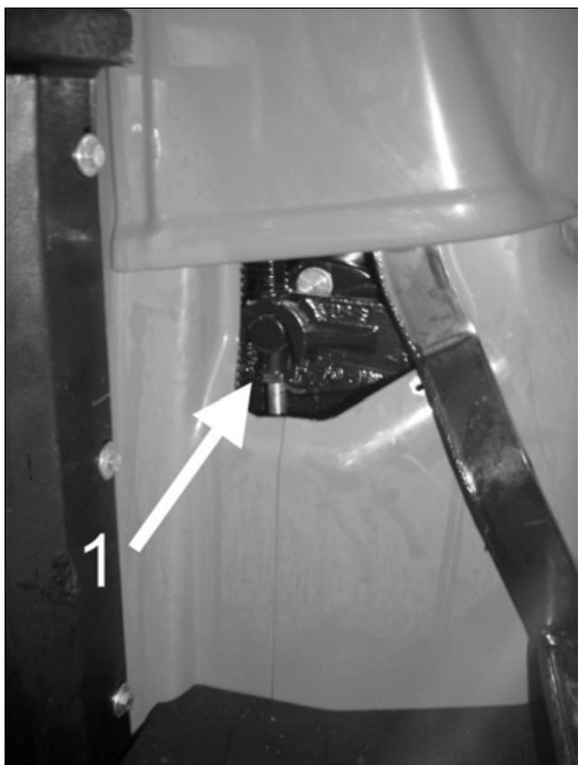
Per effettuare la registrazione occorre smontare il coperchio comandi frizione e svitare la vite di registro 1 per aumentare il gioco libero del pedale, avvitarla per diminuirlo. A registrazione effettuata rimontare il coperchio.
