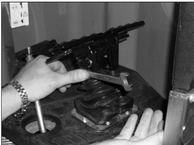
Smontare i pedali freno, la protezione in gomma, il pedale bloccaggio differenziale ed il pedale acceleratore.
