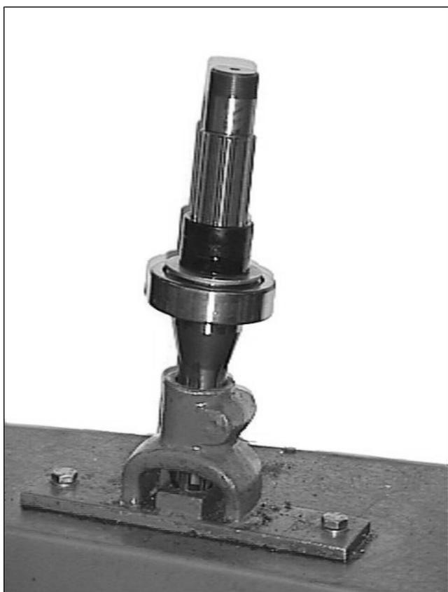
Posizionare l'albero presa di forza su di un supporto e pre-montare il cuscinetto, il distanziale e la boccia dell'ingranaggio. Il cuscinetto è speciale, prestare attenzione al verso di montaggio.
