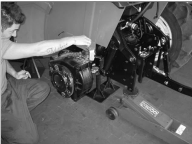
Dopo aver smontato la ruota completa occorre svitare le viti posteriori di fissaggio della piattaforma al supporto posteriore modulo guida.
