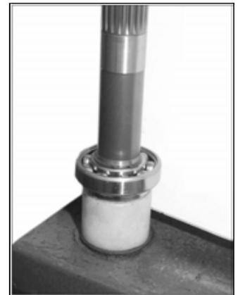
In fig. 59 viene riportato il complessivo di montaggio della parte iniziale dell'albero primario superiore che nelle fig. 60 e fig. 61 viene premontato, collocando in posizione la tenuta che andrà ad operare sulla frusta montata nelle operazioni precedenti. Questa tenuta è evidenziata con la lettera **M** in fig. 59. Successivamente sull'albero è possibile montare il cuscinetto posteriore (cuscinetto **R** di fig. 59a).
