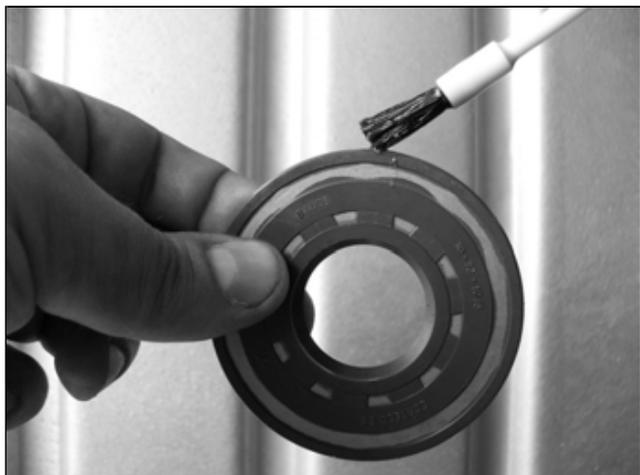
Rimontare il paraolio esterno applicando del mastice per guarnizioni.
