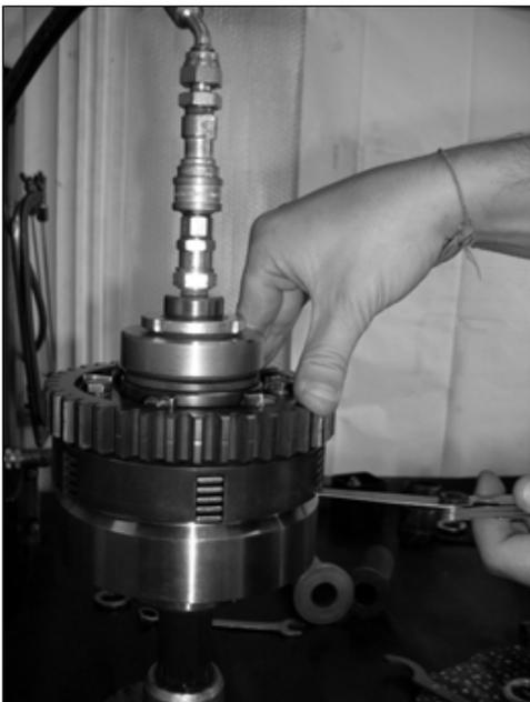
Portando la pressione a 42 bar mediante una pompa idraulica, verificare con spessimetro il gioco tra i dischi frizione e il pacco molle, tenendo premuto l'ingranaggio con la mano, che deve essere di  $0,8 \div 1,4$  mm. Qualora il gioco non rientri nella misura prevista occorre variare i distanziali cementati di 1 mm + 1,2 mm montati in precedenza.
