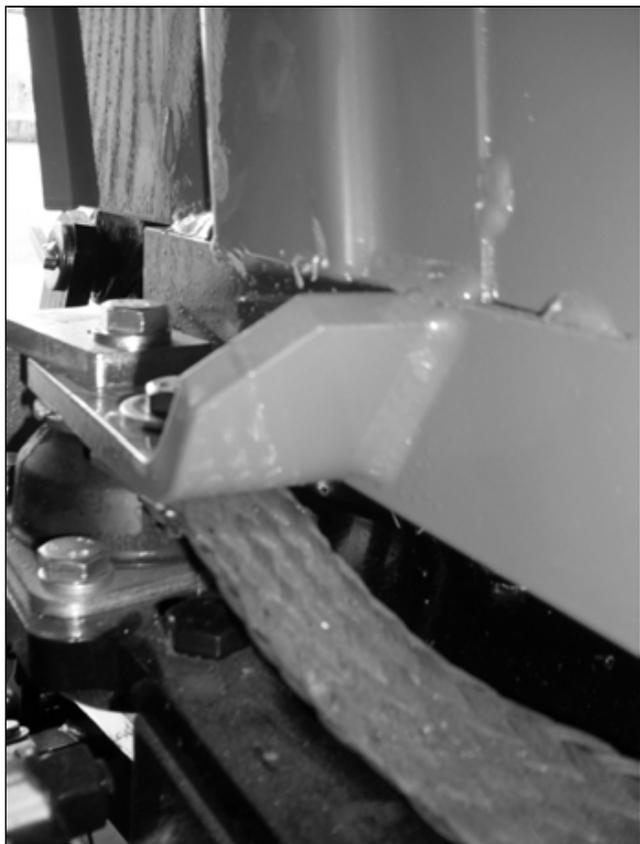
Scollegare il cavo di massa e svitare la vite di fissaggio della piattaforma.
