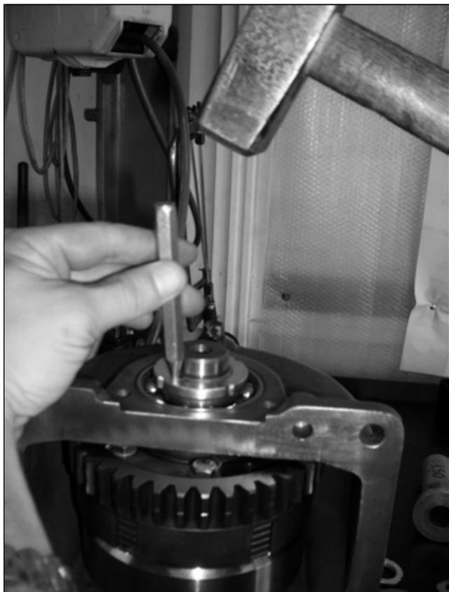
Una volta serrata la ghiera di fermo a 22 Kgm, occorre bulinarla per evitare che si sviti.
