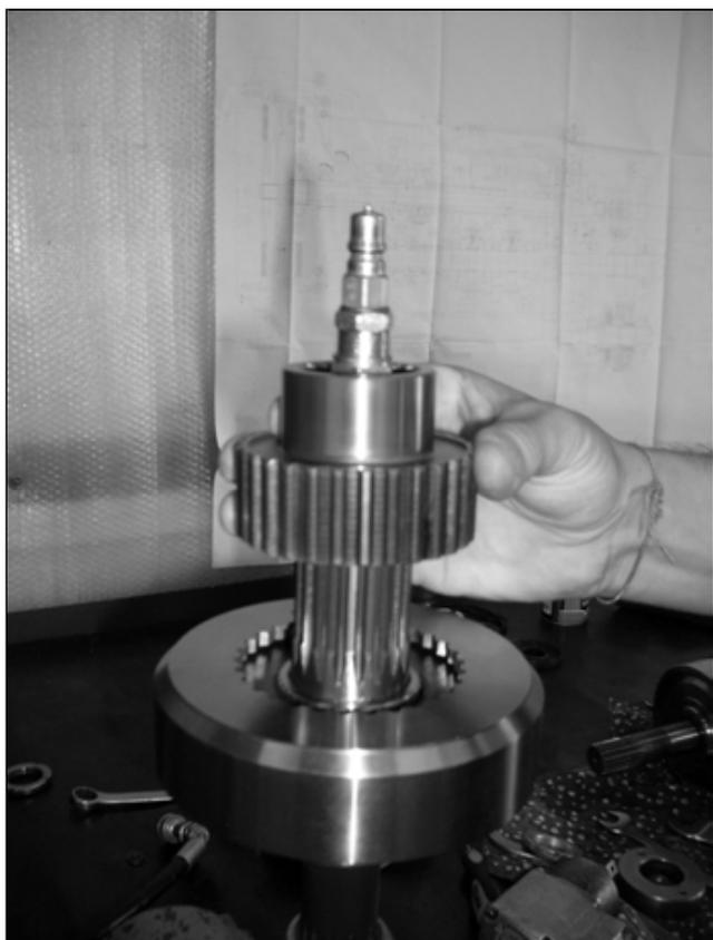
Posizionando l'albero traz. ant. a banco, rimontare il tamburo compl. di molle a tazza e la boccola di trascinamento.
