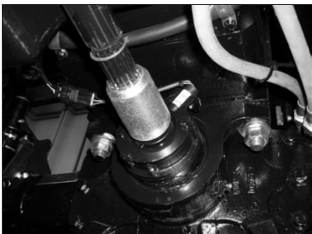
In figura è evidenziato il sensore tachimetrico. Si ricorda che il sensore deve essere registrato ad una distanza di  $0,5 \div 2$  mm dalla ruota fonica.
