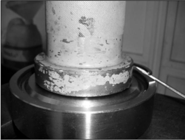
Mediante l'ausilio di una pressa (con una capacità di carico di almeno 500 Kg), comprimere il pistone del pacco molle e rimuovere l'anello di fermo.
