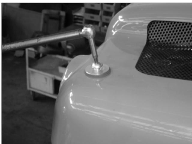
Svitare le quattro viti di fissaggio del tettuccio alla cabina e fissare i quattro golfari per il sollevamento della cabina.
