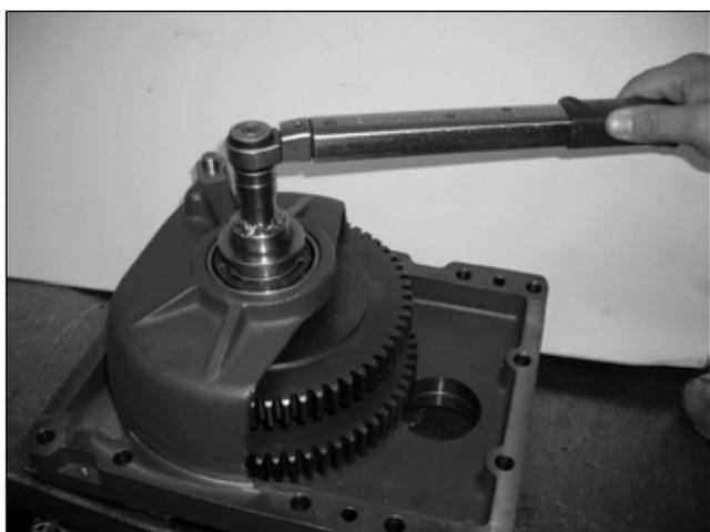
Riveste particolare importanza il serraggio della ghiera che fissa l'albero inferiore della presa di forza. Effettuare un primo serraggio con chiave dinamometrica a 2,5 Kgm, dopodiché effettuare un segno di riferimento sulla ghiera. A questo punto effettuare un secondo serraggio con chiave dinamometrica a 20,0 kgm.
