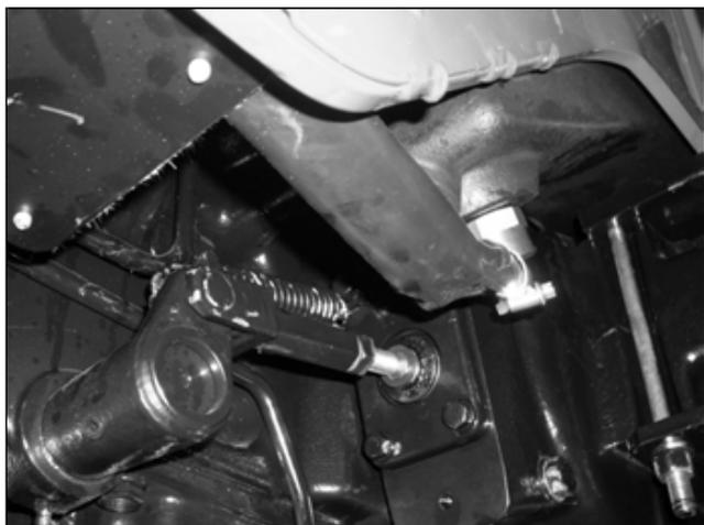
Nel caso sia necessario sostituire il coperchio di protezione sul mozzo sx occorre smontare il tirante di collegamento della leva rinvio freno al tirante della massa frenante, la molla di ritorno e la flangia attacco coperchio.
