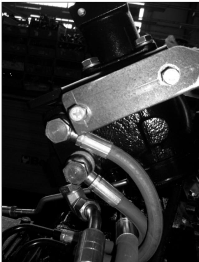
Scollegare i due tubi di mandata dall'idroguida al cilindro di sterzo. Prima di scollegare i tubi, contrassegnarli in modo da evitare di invertire il senso di marcia.
