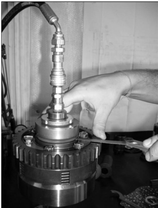
Portando la pressione a 42 bar, verificare con spessimetro il gioco tra l'ingranaggio e la rondella calettata che deve essere di  $0,3 \div 0,5$  mm.
